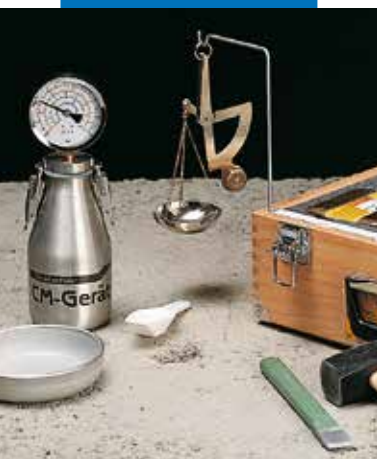
Metten van vocht in Mapecem dekvloeren met een carbid hygrometer
