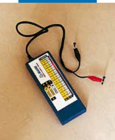
Metten van vocht in Mapecem dekvloeren met een elektronische hygrometer
