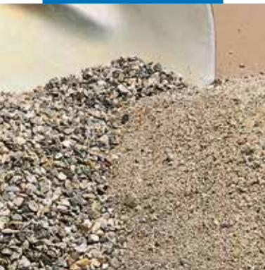
Toeslagmateriaal voor Mapecem; grind van 4 tot 8 mm - zand van 0 tot 4 mm
