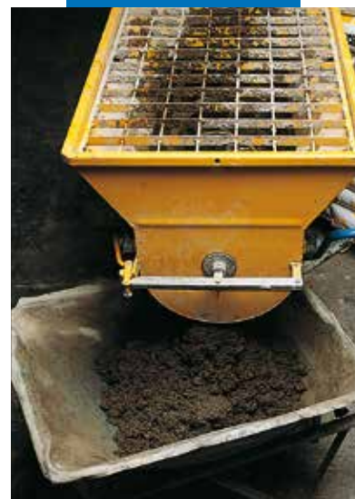
Mapecem gemengd in een kleine betonmolen
